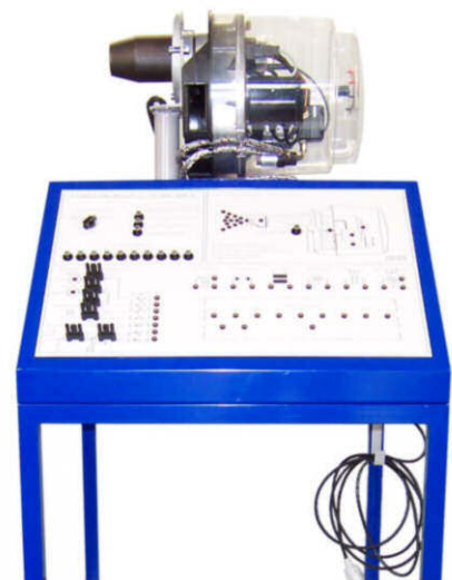
Abbildung zeigt den Schulungsstand Ölgebläsebrenner Bestellnummer 0000 9614
