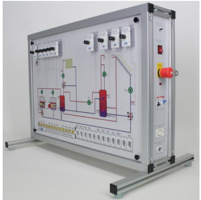
Abbildung zeigt die Seitenansicht des Kompaktmodells mit integriertem Sicherheitsblock und FI-Schutzschalter
