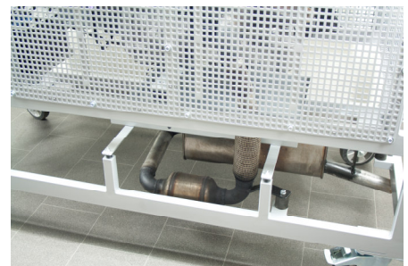
Abbildung zeigt 4-Wege-Katalysator Partikelfiltersystem für Ottomotoren
