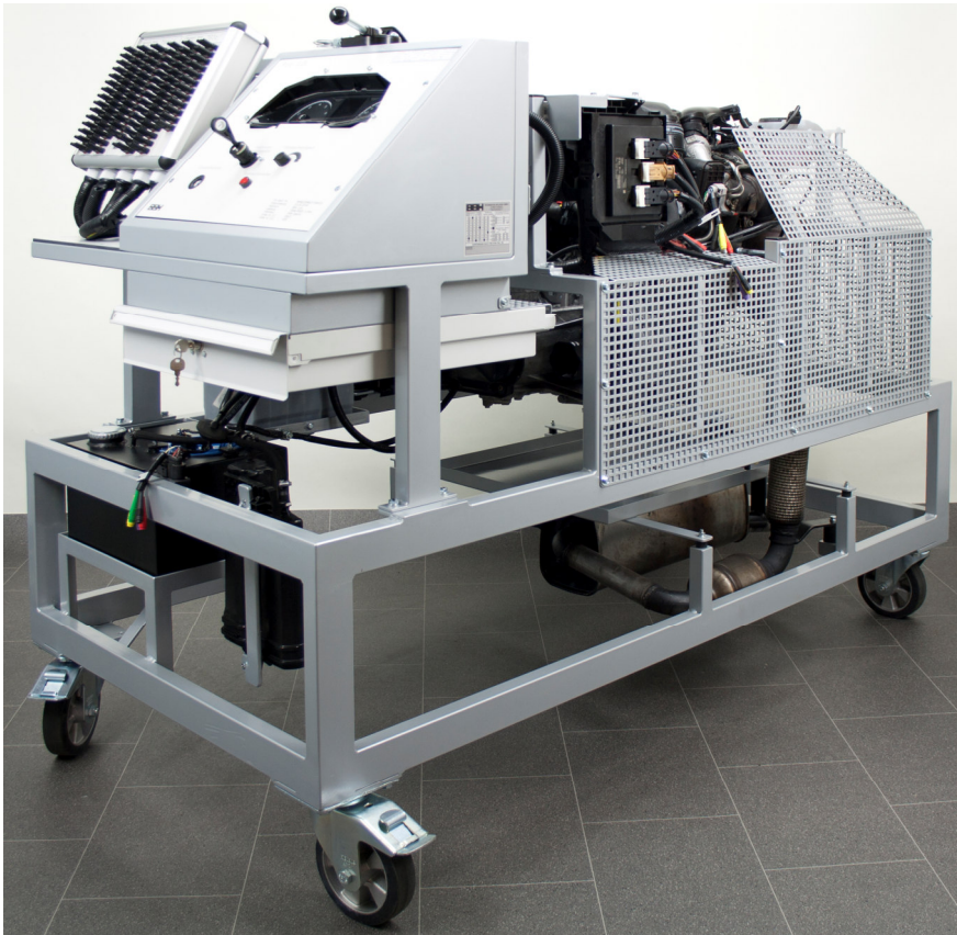
Abbildung zeigt den 4 Zylinder Funktionsmotor VW 1,5 TSI OPF Euro 6 Bestellnummer 000G 9116
